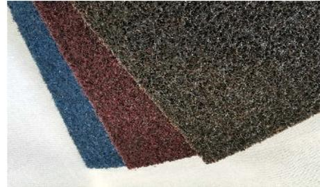
**Produktaufbau:** durchgenadeltes Faservlies mit harzgebundenem Schleifmittel
